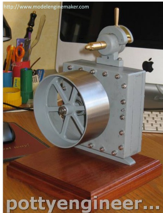
Moteur terminé avec son inverseur
